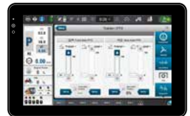
Intuitives Layout für die automatische Ein/Aus-Einstellung für die höhenabhängige Front- und Heckzapfwellenautomatik
