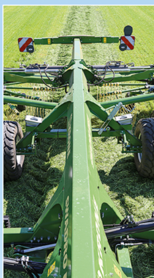
Der neue trapezförmige Rahmen soll Schwingungen vermeiden und den Kraftfluss verbessern.
